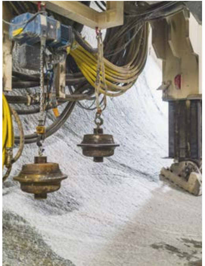
Mit Hartmetall gegen Hartgestein: Zwei Meissel zu je 240 Kilogramm warten auf ihren Einsatz im Bohrkopf.
