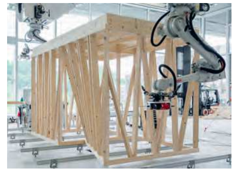
Vorfabrikation des Holzrahmenmoduls im Robotiklabor der ETH Zürich. Foto: Gramazio Kohler Research, ETH Zürich
